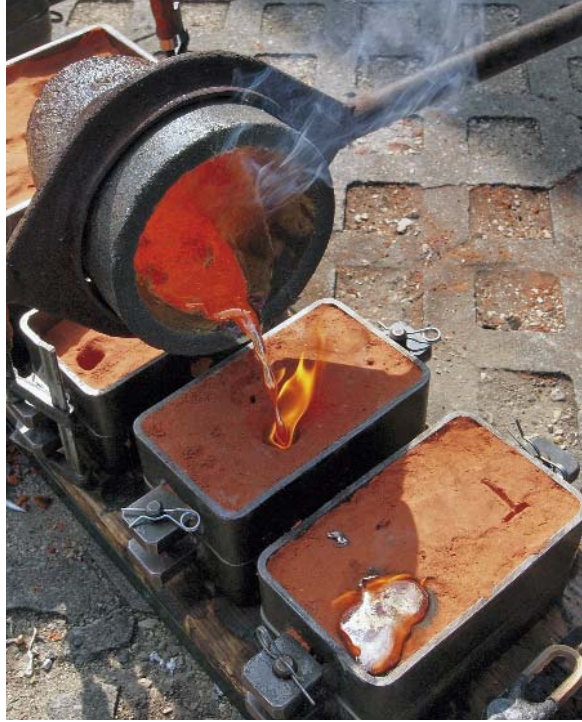
...geschmolzen, wird es aus dem Tiegel in die Formkästen gegossen
