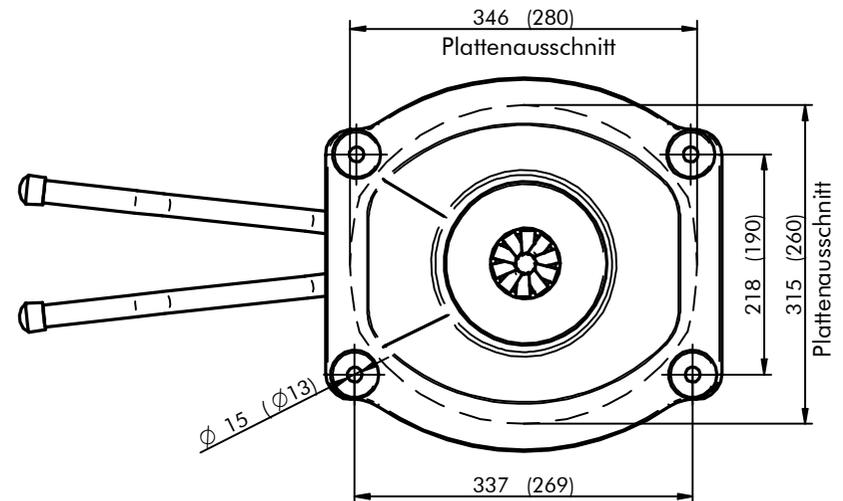
Das Esseisen C10 unterscheidet sich vom C15 nur in der Größe der Feuerschüssel. Das Unterteil und die Wirbeldüse sind identisch.
